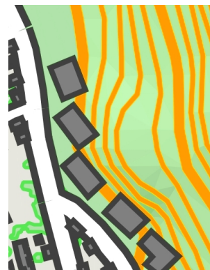
3. Données finales avec le modèle GAEL : les bâtiments ont poussé le relief en se déplaçant.
